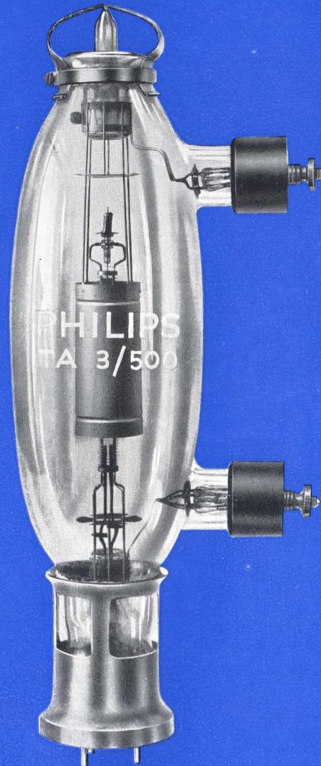
Mit dieser Röhre lässt sich bei einer Anodenspannung von nur 3000 V eine hohe Nutzleistung erzielen. Dank der grossen Steilheit (6,0 mA/V) ist ein hoher Wirkungsgrad erreichbar. Der hohe zulässige Anodenverlust verbürgt eine grosse Betriebssicherheit der Röhre.
